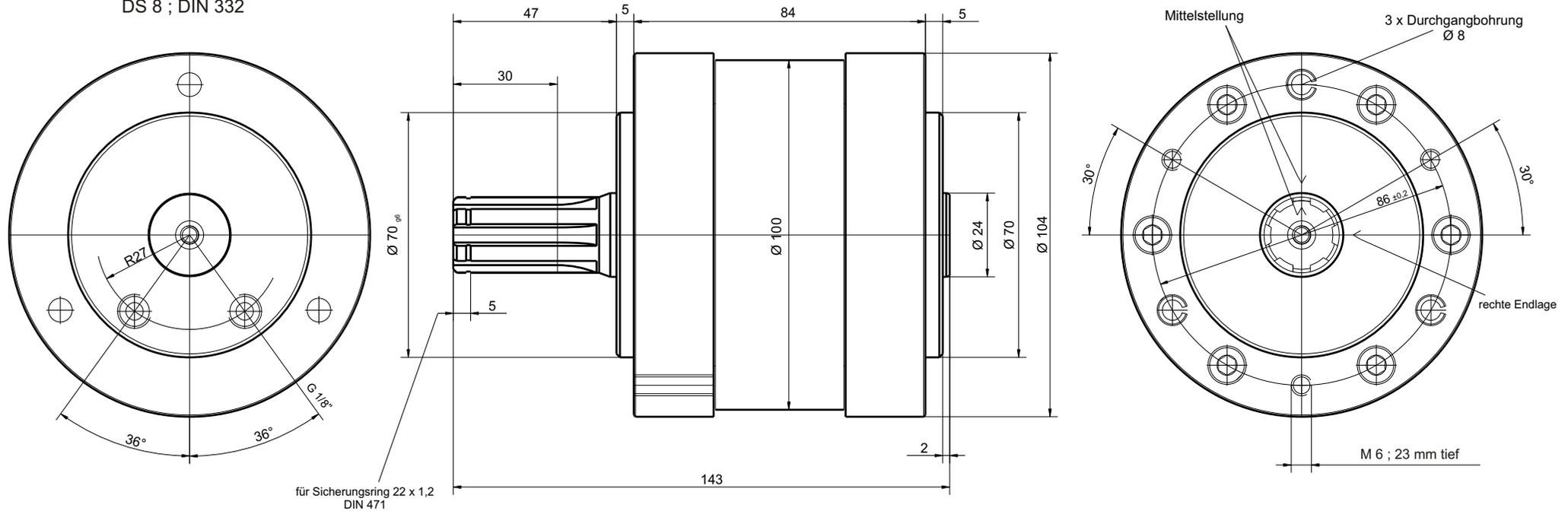
Keilwellenprofil B 6 x 18 x 22; DIN 5463 flankenzentriert; geschliffen
