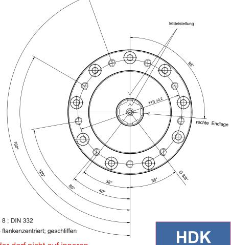
Zentrierung an beiden Wellenenden DS 8 ; DIN 332
