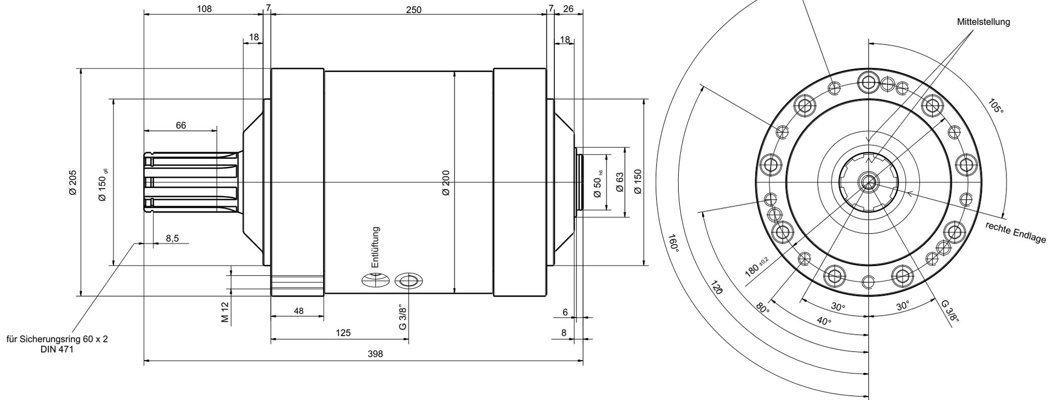
Zentrierung an beiden Wellenenden DS 12; DIN 332
